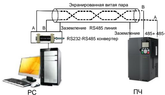
Рис 9.1 Подключение RS485 к одному ПЧ
